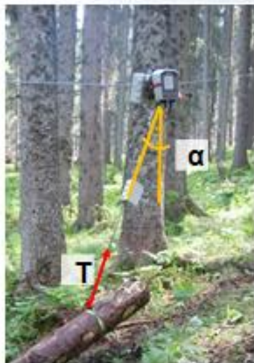
Uso di celle di carico ed inclinometri
