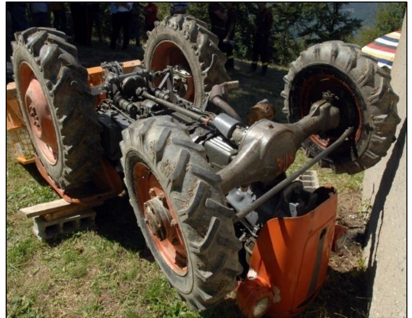
Ribaltamento del trattore con rotazione di 180°
