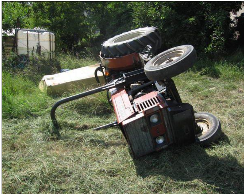
Ribaltamento del trattore con inclinazione a 90°
